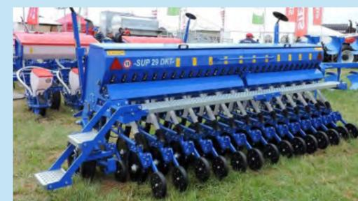
Utilaj cu trepte de acces din panouri perforate
