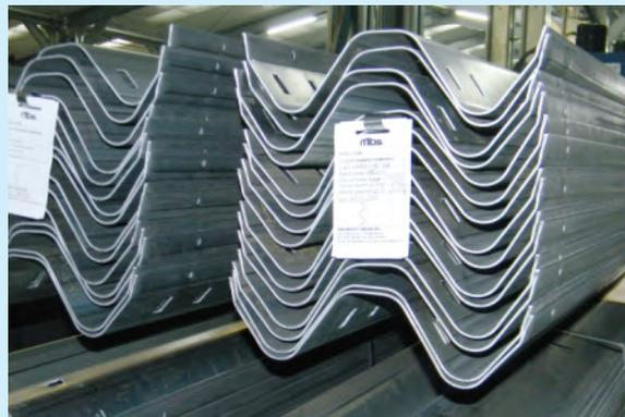
Divizia pentru Infrastructură produce două tipuri de lise: de tip SP-61 cu două ondule pentru parapete deformabile de tip semigreu, greu și foarte greu, cu lungimi standard de 3200, 4200 sau 6200 mm precum și nestandard conform solicitărilor cu perforații rectangulare și lise cu două ondule, de diferite dimensiuni cu perforații ovale sau de tip lacrimă (pentru șuruburi cu nas).
